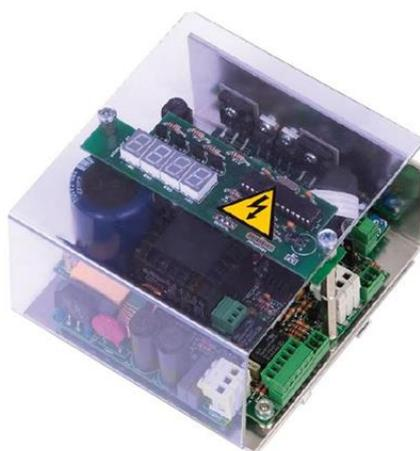
Per rispetto della normativa **EMC** il circuito è dotato di filtro con correnti di perdita verso terra inferiore a 1mA. Il circuito fornisce al vibratore un segnale di comando modulato in larghezza di impulsi (**PWM**) regolabile sia in **Ampiezza** (tramite segnale analogico) che in **Frequenza** tramite trimmer TR1. Tale segnale è compensato nei confronti delle variazioni della tensione di linea.
