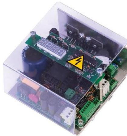
Um die **EMV-Vorschriften** zu erfüllen, ist die Schaltung mit einem Filter mit Ableitströmen gegen Erde von weniger als 1mA ausgestattet. Die Schaltung versorgt den Vibrator mit einem pulsbreitenmodulierten (**PWM**) Steuersignal, das sowohl in **der Amplitude** (über Analogsignal) als auch in **der Frequenz** über Trimmer TR1 einstellbar ist. Dieses Signal wird für Netzspannungsschwankungen kompensiert.
